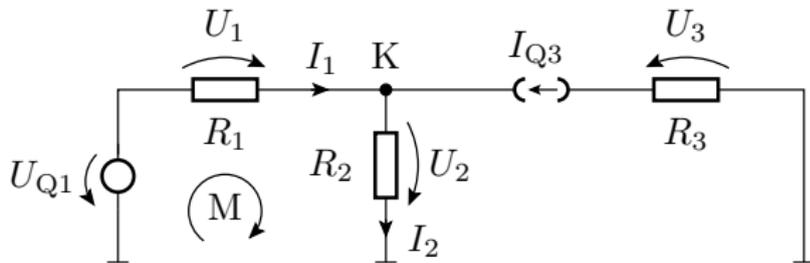
Für die Berechnung der Ströme  $I_1$  und  $I_2$  sowie der Spannungen  $U_1$  und  $U_2$  genügen die Gleichungen:
